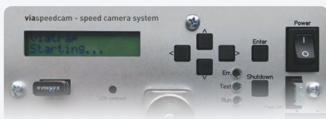
Panneau de contrôle intégré dans le boîtier batterie
